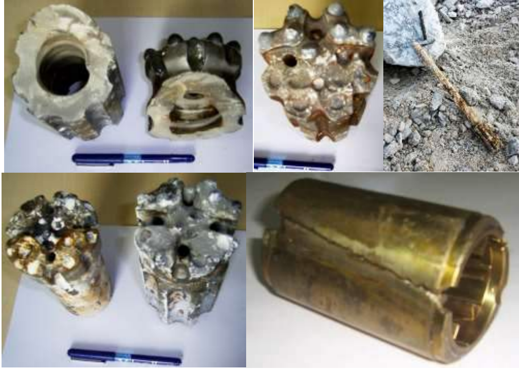
Şekil 8. Matkap uç, gövde, şank ve tijlerde gözlemlenen kırılmalar
