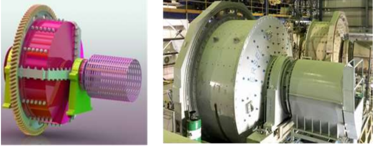
Şekil 3. Yarı otojen (SAG Mill) değirmenin görüntüsü
