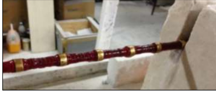
Şekil 4. Kesimde kullanılan elmas telin görünümü
