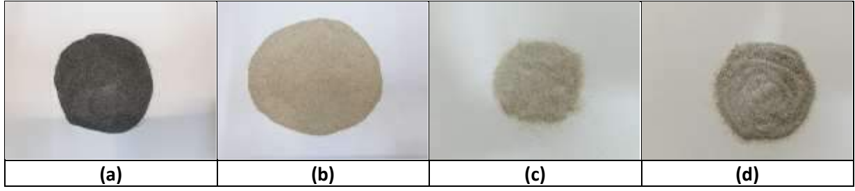
Şekil 10. -212+0,038 mm fraksiyonu sarsıntılı masa zenginleştirme ürünleri (a) konsantre (b) ara ürün (c) artık (d) besleme
