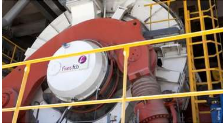
Şekil 5. Horomill (yatay valsli değirmen) endüstriyel uygulama görüntüsü
