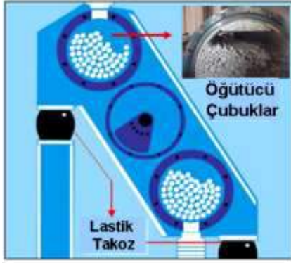
Şekil 12. Titreşimli değirmenin kesit görüntüsü ve uygulaması
