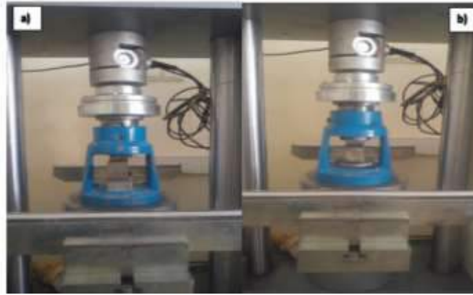
Şekil 1. a) Eğilme dayanımı, b) Basınç dayanımı.
