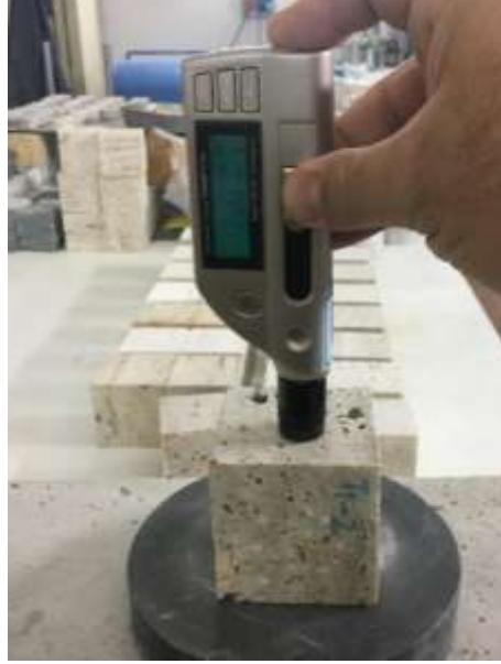
Şekil 3. Çalışmada kullanılan portatif sertlik cihazının görünümü.
