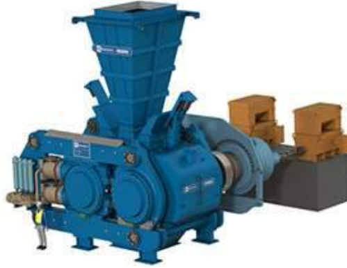
Şekil 7. Yüksek basınçlı merdaneli değirmenin görüntüsü (Flsmidth,2016)
