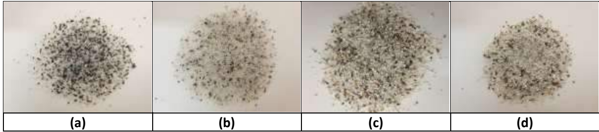
Şekil 8. -1+0,5 mm fraksiyonu sarsıntılı masa zenginleştirme ürünleri (a) konsantre (b) ara ürün (c) artık (d) besleme
