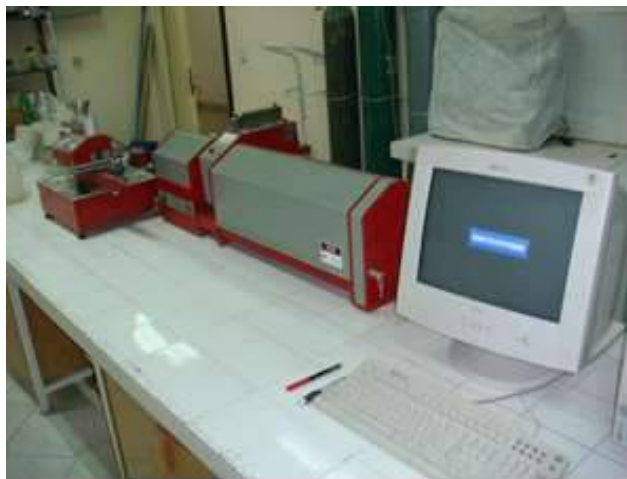
Şekil 6. Çalışmada kullanılan Sympatec Magic KFS 153 marka lazerli tane boyu ölçme cihazı
