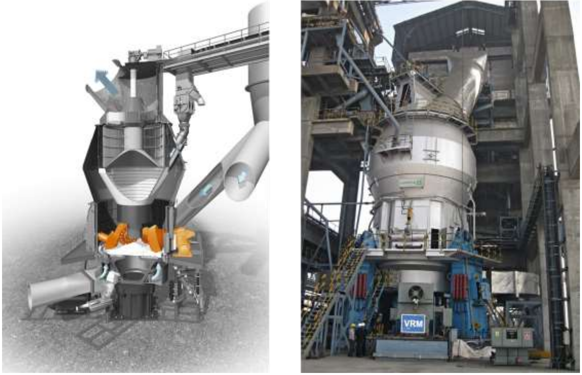
Şekil 4. Valsli değirmen ve endüstriyel uygulaması (Loesche,2016)
