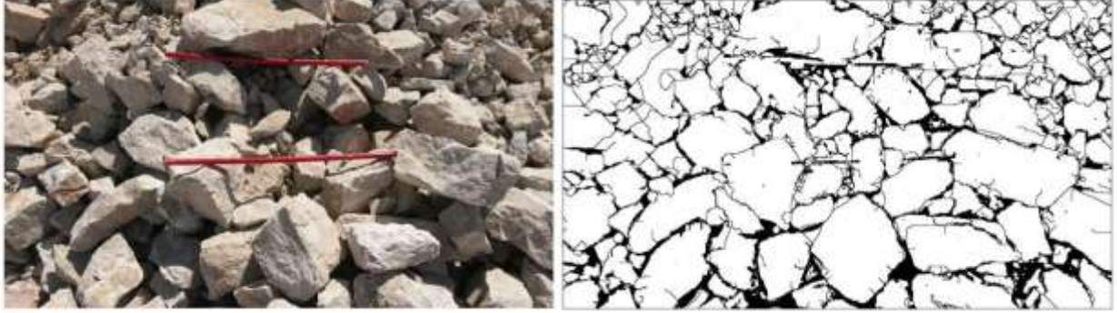
Şekil 10. Tane boyutu ölçekli fotoğraf analizi
