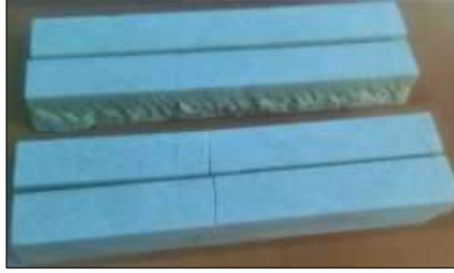
Şekil 4. Uzunlukları boyunca kesilmiş ve parçalara ayrılmış numuneler
