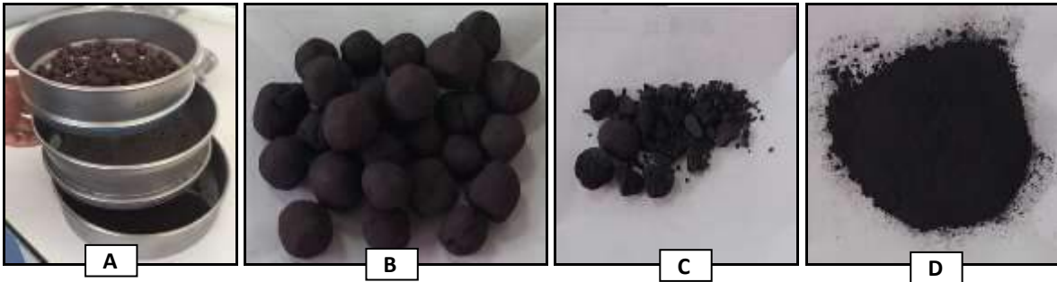
Şekil 6. A) Pelet tambur aşınma deneyleri neticesinde elde edilen malzemenin +6,3 mm ve -600 mikron eleklerden elenmesi, B) +6,3 mm malzeme "tambur indeksi", C) -6,3 mm +600 mikron malzeme D) -600 mikron malzeme "aşınma indeksi"
