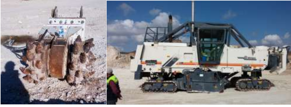
Şekil 11. Tamburlu kazıcı başlığı ve paletli kazıyıcı.
