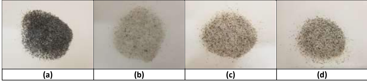
Şekil 9. -0,5+0,212 mm fraksiyonu sarsıntılı masa zenginleştirme ürünleri (a) konsantre (b) ara ürün (c) artık (d) besleme
