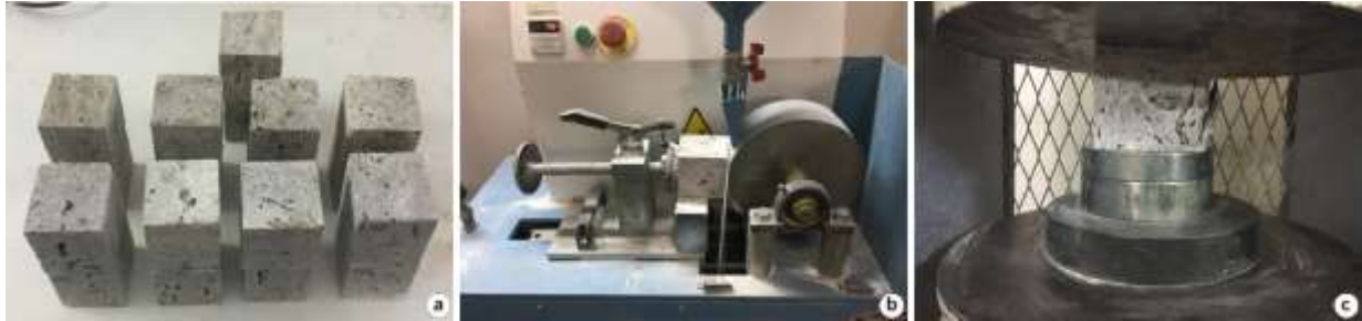
Şekil 4. a) Fiziko-Mekanik deneylerde kullanılan 7x7x7 boyutlu küp örneklerin görünümü, b) Dikey aşınma deneyinin uygulanışından bir görünüm, c) Tek eksenli basınç deneyinden bir görünüm.
