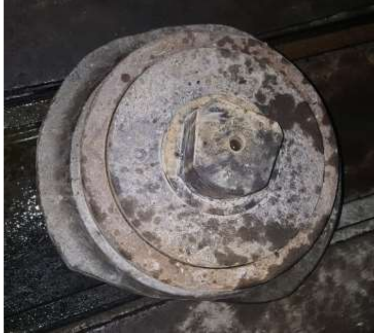
Şekil 5. Normal aşınmayla beraber tek taraflı aşınmaya maruz kalan disk.
