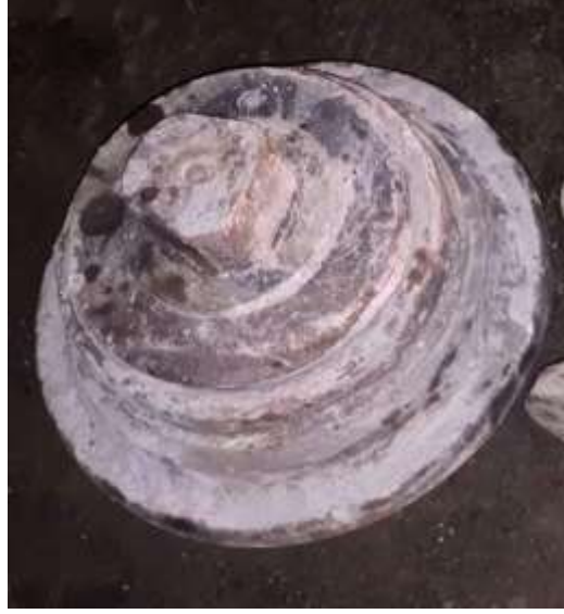
Şekil 3. Normal aşınmaya maruz kalan disk.
