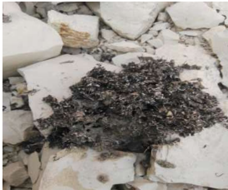
Şekil 11. Öğütme İşlemi Sırasında Kuyu Ağzından Gelen Metal Talaşlar
