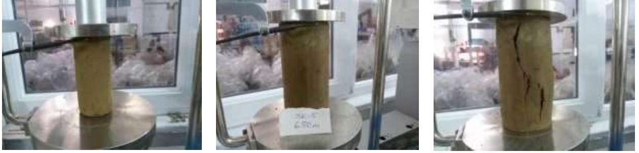
Şekil 2. Serbest basınç deneyine tabi tutulmuş olan numunelerden görünümüler.
