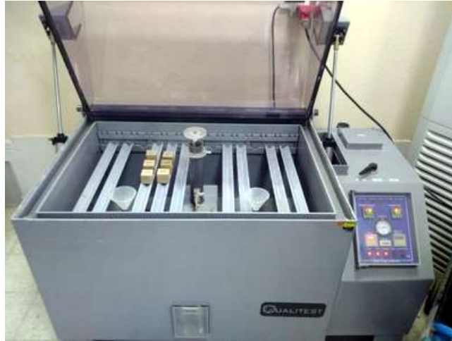
Şekil 3. Tuz buharıyla yıpranmaya karşı direncin tayini test kabini
