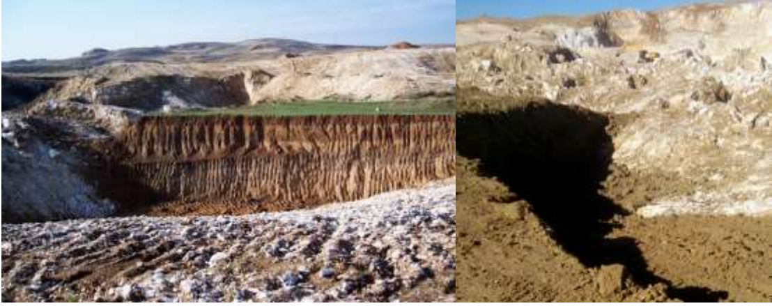
Şekil 9. Örtü kazısı sıyırma ve dolin temizliği.
