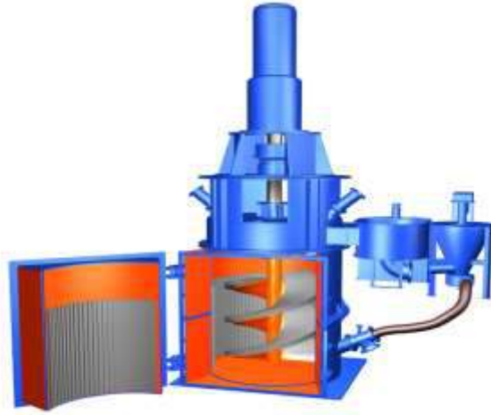
Şekil 8. Karıştırmalı bilyalı değirmenin görüntüsü
