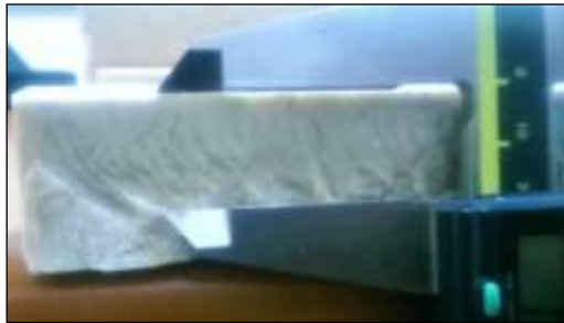
Şekil 5. Kesim hattında kesme derinliği ölçümü
