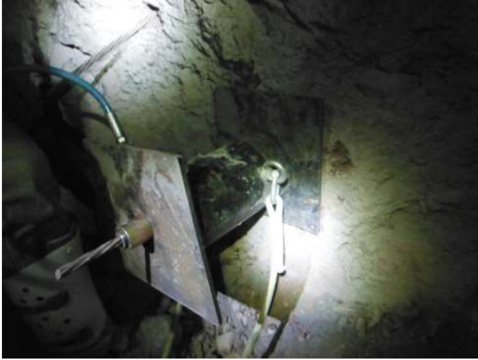
Şekil 2. Halat saplama için çekme krikosu
