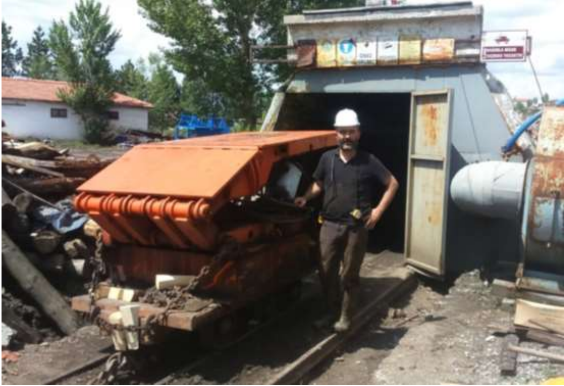
Şekil 3. Yozgat Sorgun yeraltı ocağına üretilen yürüyen tahkimatların indirilmesi
