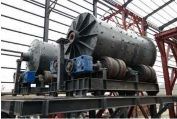
Şekil 1. Çubuklu değirmenin genel görüntüsü
