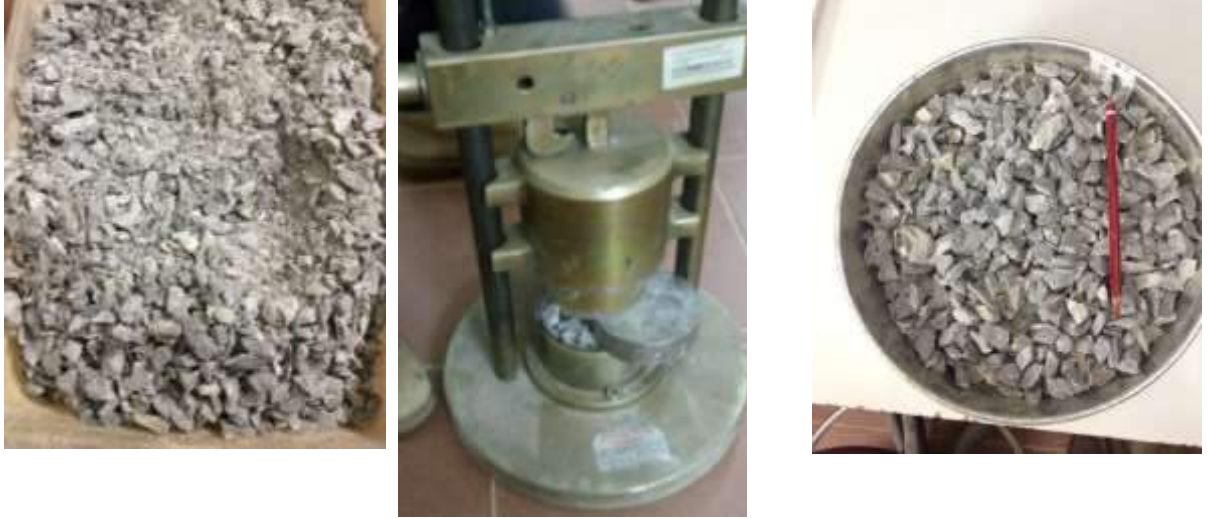
Şekil 6. Los Angeles ve Darbe Dayanım deneyleri için hazırlanmış olan granüler malzemenin görünümü.
