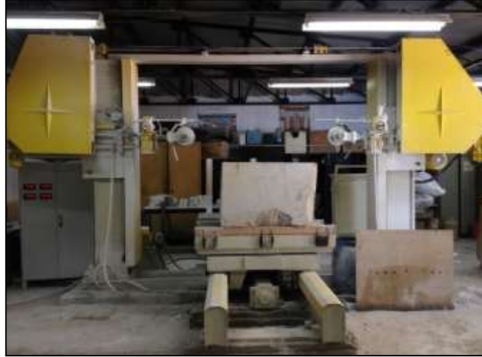
Şekil 1. Tektelli blok kesme makinesinin genel görünümü
