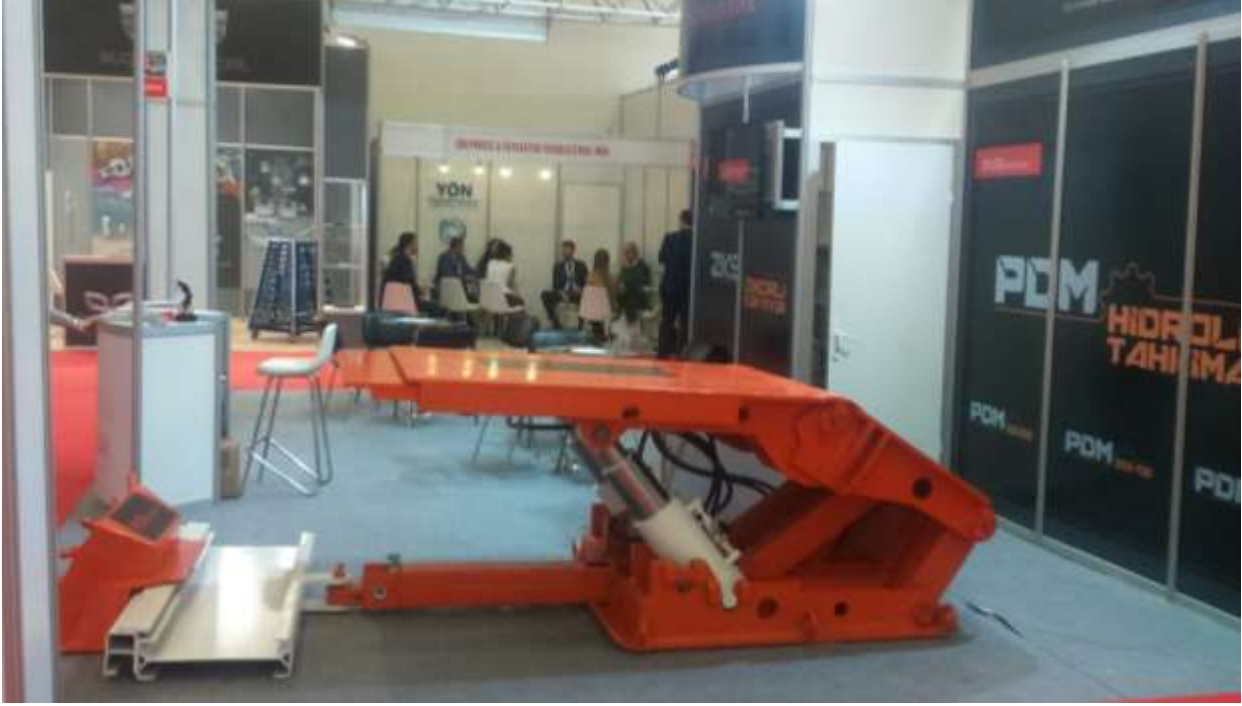
Şekil 2. Muda Mühendislik tarafından üretilen ilk yürüyen tahkimat
