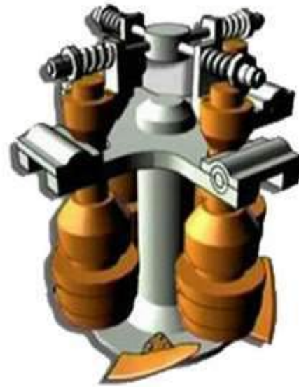
Şekil 13. Sarkaç toplu değirmen ve sarkaç toplarının görüntüsü
