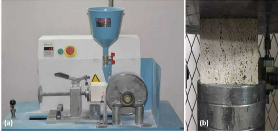
Şekil 5. D_A deney cihazı ve aşınan örneğin görünümü (a), TSD deneyinden görünüm (b).
