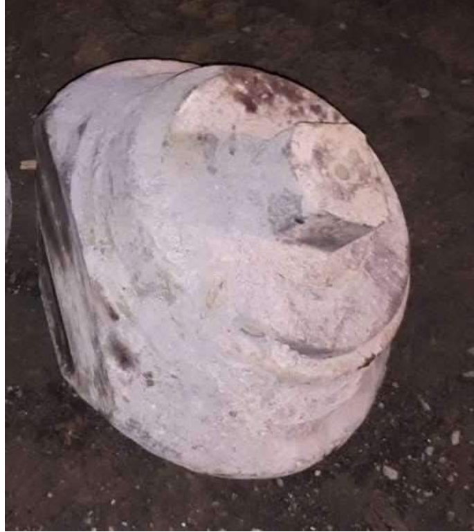
Şekil 4. Tek taraflı aşınmaya maruz kalan disk.
